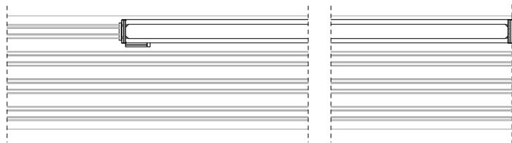
2. Das zweite Glaspaneel in der Oberschiene in die 2. Spur schieben und anschließend auf die gleiche Spur in der Unterschiene sacken lassen.
